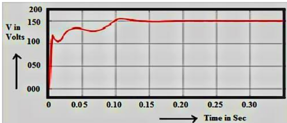
Fig. 8 – Rectifier output voltage.
