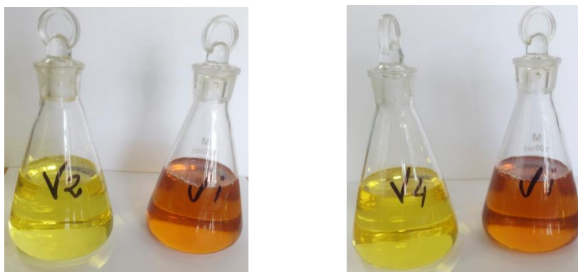
Fig. 8 – Probele de ulei înainte și după procedura de tratare cu cele două variante structurale de adsorber compozit C2 (stânga) și C4 (dreapta).
