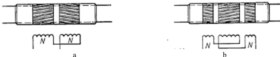
Fig. 9 – Variante constructive ale arborelui de măsurare: a – două zone, b – trei zone de măsurare.
