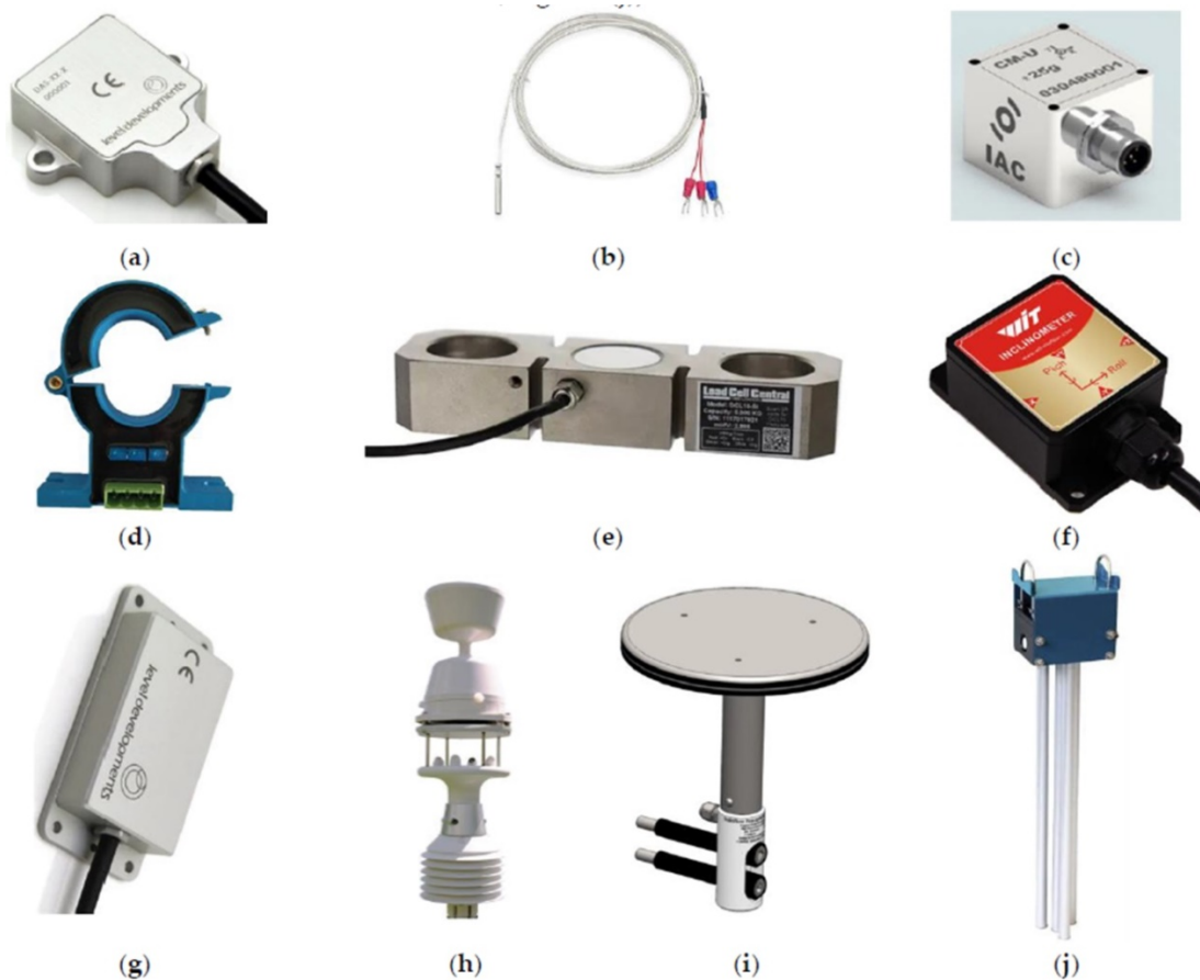
Fig. 2. Rețea de senzori pentru sistemul de monitorizare a cablurilor liniilor electrice aeriene: (a) Senzor de înclinare pentru măsurarea unghiurilor cablului; (b) Senzor de temperatură a cablului; (c) Accelerometru pentru măsurarea vibrațiilor cablului; (d) Senzor de tip Hall pentru măsurarea curentului din cablu; (e) Senzor de tensiune mecanică a cablului; (f) Accelerometru pentru măsurarea vibrațiilor stâlpilor; (g) Senzor de înclinare pentru măsurarea unghiurilor stâlpilor; (h) Senzor de umiditate relativă și temperatură, viteza și direcția vântului, radiația solară globală, presiunea barometrică, precipitații; (i) Senzor de grindină; (j) Senzor de detectare a gheții.
