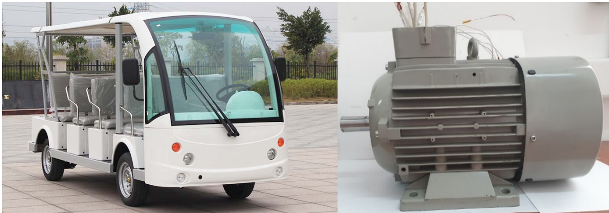
Fig. 1 Vehiculul electric alimentat cu baterii și prototipul mașinii asincrone cu 5 faze
