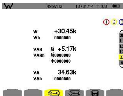
Fig. 6 Puterile măsurate în secundarul transformatorului.
