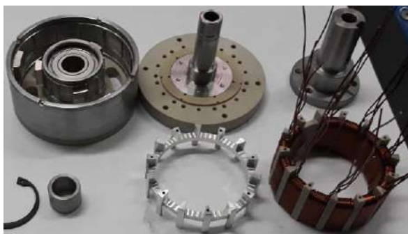
Fig.7. Piese componente ale microgeneratorului cu „dublă excitație” [9].
