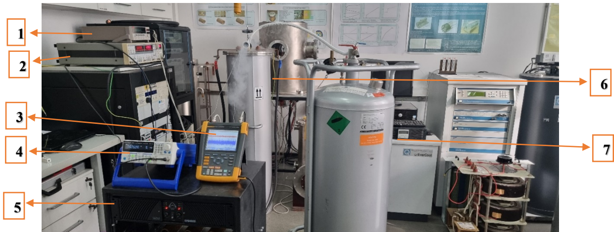
Fig. 14. Sistemul de măsurare folosit pentru testarea limitatorului supraconductor HTS rezistiv în c.a.
